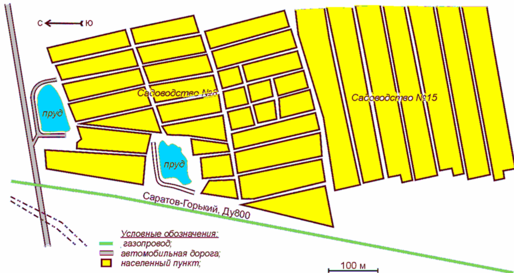
Ситуационный план места нарушения минимального безопасного расстояния от газопровода
