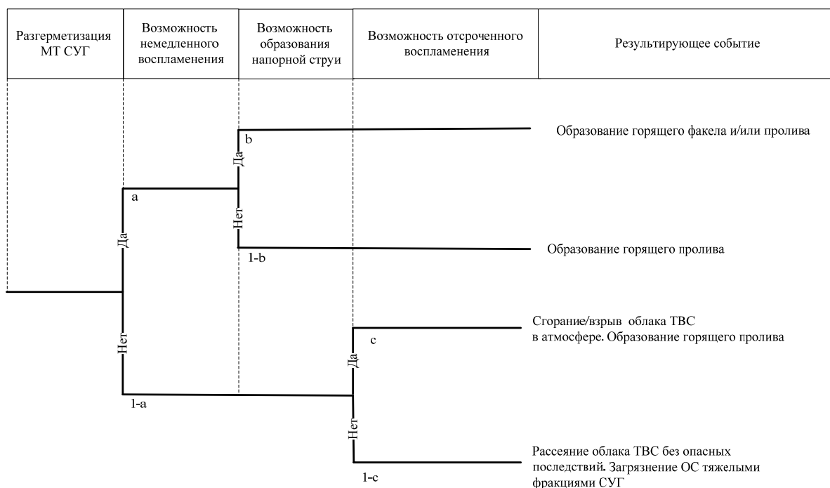
Рисунок 9 – «Дерево событий» при разгерметизации подземного участка МТ СУГ
